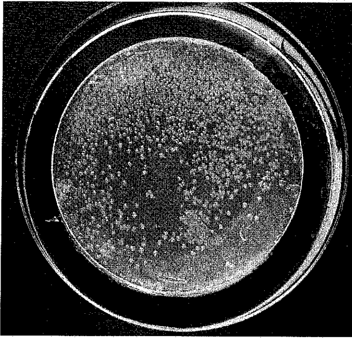
FOTO n. 1 Tampone prelevato da superficie di Laminam contaminata con una sospensione microbica contenente 2 \times 10^5 cfu/ml: colonie confluenti, non numerabili
